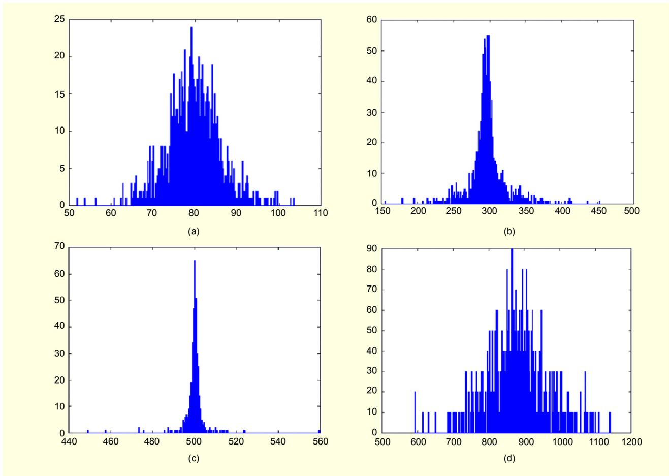
Fig. 6. Histogram of GOP-rate distribution: (a) 80 kbps, (b) 300 kbps, (c) 500 kbps, and (d) 900 kbps.
