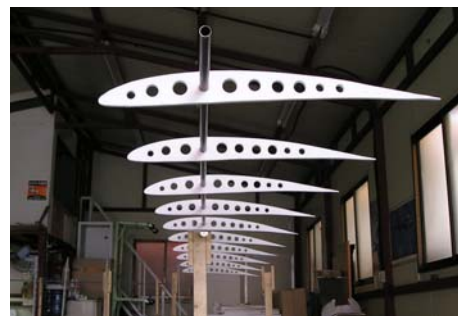
Fig 5. 전형적인 인력비행기 스파와 리브의 날개 구조
