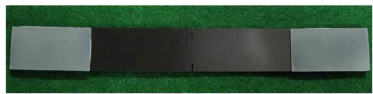
Fig. 6 완성된 CFRP 복합재 시편
