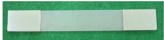
Fig. 5 완성된 GFRP 복합재 시편
