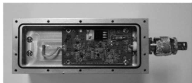
그림 3 UHF 센서모듈의 제작사진 Fig. 3 The picture of UHF sensor module
