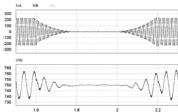
(d) the input currents of PWM rectifier and dc-link voltage
