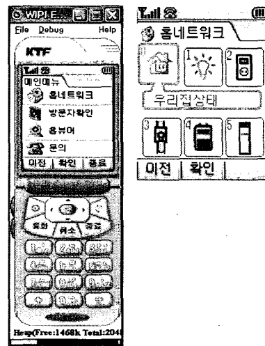
그림 10. XML 데이터에 의해 구성된 UI의 예
