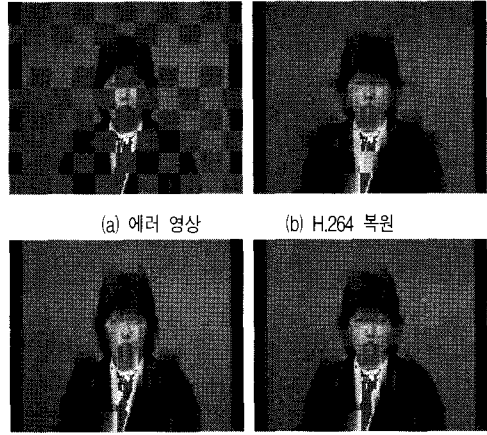
(a) 예러 영상 (b) H.264 복원 (c) Xu 방법[1] (d) 적응적 복원 그림 8. claire 영상의 테스트 결과 화면
