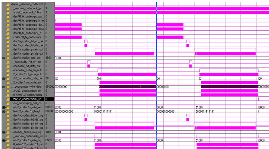
그림 10. ModelSim에 의한 TDE 엔진 동작 검증 결과
