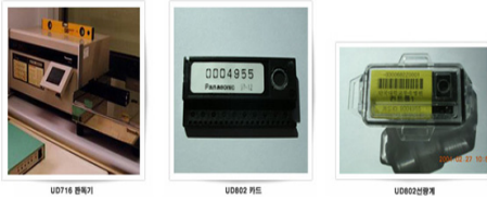
그림 2. Panasonic UD-716 AGL TLD 선량계 system
