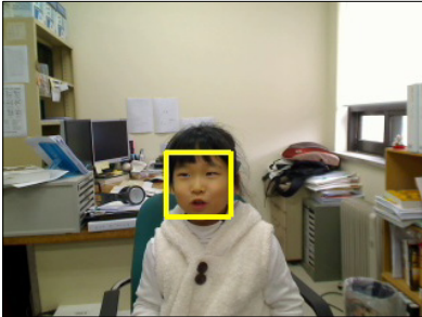
그림 2. Haar-like 특징을 이용한 얼굴탐지
