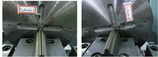
그림 1. 굽힘 모멘트 측정 시험기 및 시험 시편
