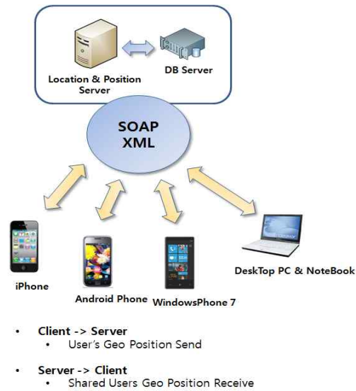
그림 4. 스마트폰에서 위치 추적 시스템 구성도
