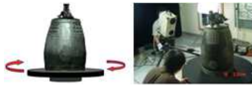
그림 7. 턴테이블을 이용한 스캔 거리 및 각도 유지
