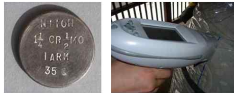
그림 15. 장비교정 시험편과 직각 측정
