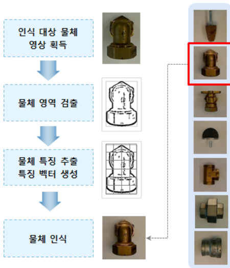
그림 1. 물체 영역 검출 및 인식 알고리즘 각 단계별 처리 영상
