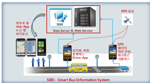
그림 1. 스마트 버스운행정보시스템 개념도
