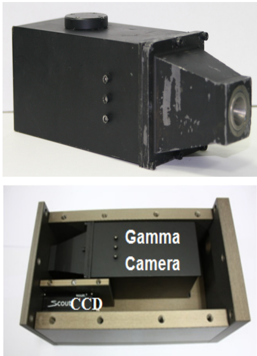
그림 4. 환경방사선 검출 전용 시스템(바늘구멍조준기+감마 카메라+전하결합소자)
