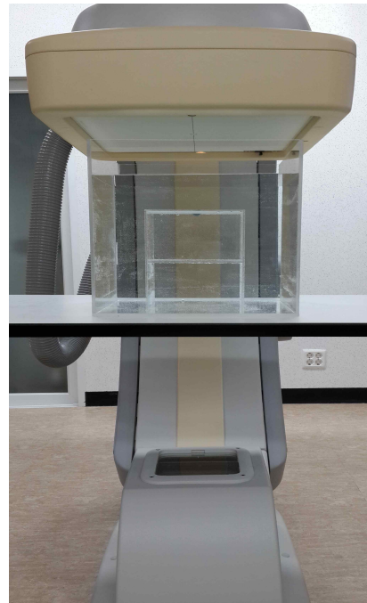
그림 3. 조영제 농도별 선량 측정 방법
