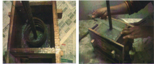
그림 17. 인발시험을 위한 시편 제조
