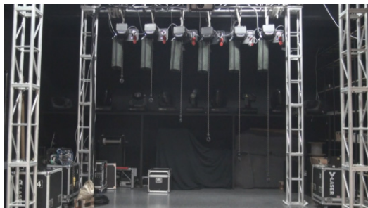
그림 8. 개별 체인 호이스트 연동 제어 실험
