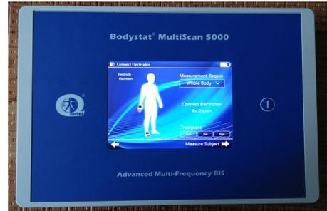
그림 1. 바이오 임피던스 분석 시스템 Bioelectrical Impedance Measurement System
