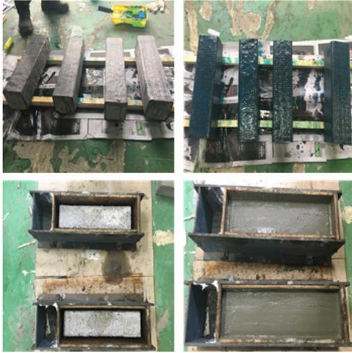
그림 3. 시험체의 제작(DFRCC 및 탄소섬유보강)
