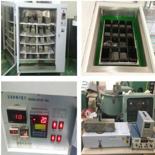
그림 4. 동결융해 시험 전경
