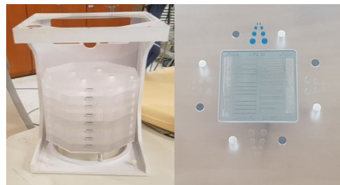
그림 3. 분해능 측정을 위한 NEMA 팬텀의 설정
