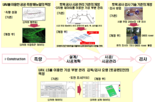
그림 8. 일본 i-Construction 내용(건설단계별)
