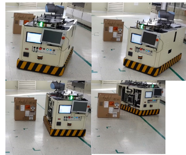
그림 7. 실 환경에서 불특정 장애물을 회피하는 테스트 장면
