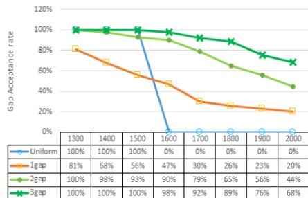
그림 5. 제어하는 차량 수에 따른 차선변경 성공률
