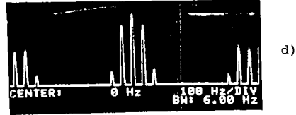
(그림 6) PWM 파형과 주파수 분포 파형
