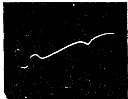
그림 7. 그림 4의 회로의 구성시 주 싸이리스터 양단 전압 (50V/div, 20 μsec/div, R_g=8\Omega , L_g=90\mu H )
