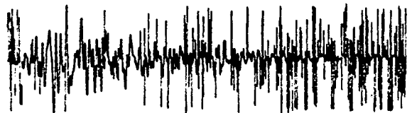
그림 4-3. 임의의 설계 응답 스펙트럼에 상응하는 인공지진가속도 (sine 함수를 이용한 경우)
