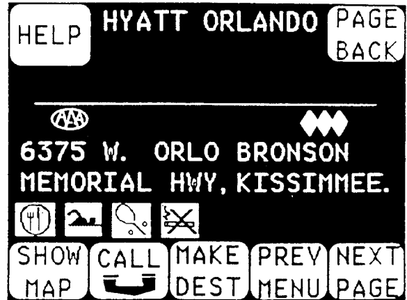
그림 9. TravTek 자동차 지역안내 화면: Hyatt Orlando 호텔의 주소와 전화번호를 나타내고 있으며, CALL을 누르면 호텔에 직접 전화연결이 되고, MAKE DEST를 누르면 목적지까지 컴퓨터지도와 음성으로 안내를 한다.
