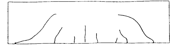
그림 8. 철근 보강 박스 거더의 균열양상
