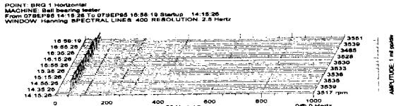
Fig. 6(a) X 축에서 베어링의 Cascade plot
