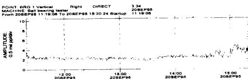
Fig. 5(a) 수직 센서에서의 시간에 따른 amplitude의 변화
