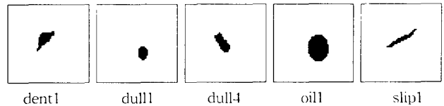
그림 8 A 클래스 분류를 위한 표준흠 패턴 영상
