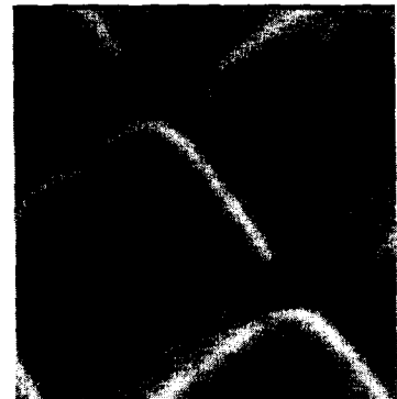
그림 6) 개선 후의 화상 시료 : Cu mesh (thickness 20µm, line 33µm, space 30µm)
