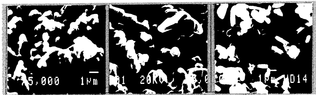
(a) 분무배소(광양2냉) (b) 유동배소CY(포항2냉) (c) 유동배소EP(포항2냉) Fig. 2. 염산페액 정제방법이 다른 산화철에 따른 Sr-ferrite 하소분말의 SEM사진
