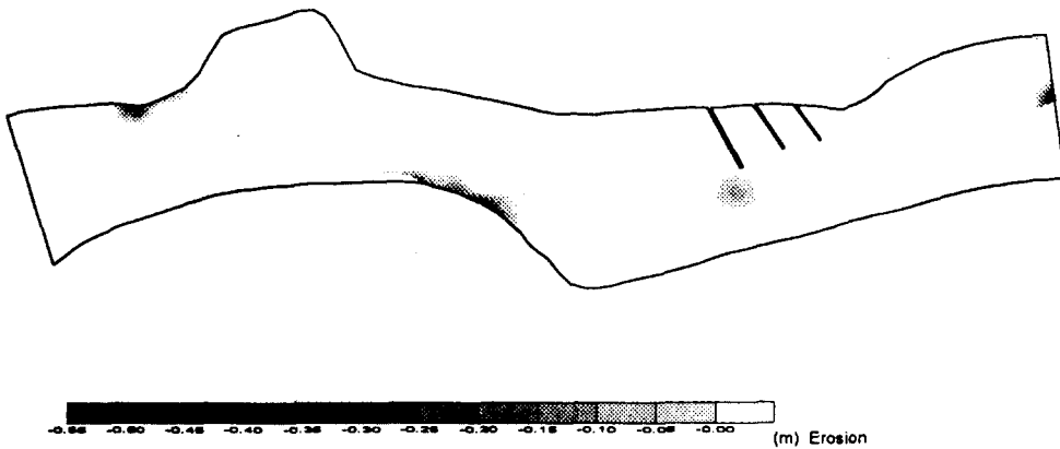
그림 6. 큰 수제공 설치에 따른 침식양상(Q=4,000 CMS)
