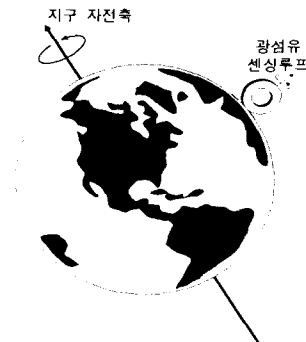
(a) 지표상의 수직축을 회전축으로 하여 정속회전하고 있는 FOG 센서
