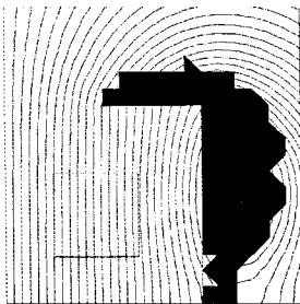
그림 6. 최종 형상에서의 등전위 분포
