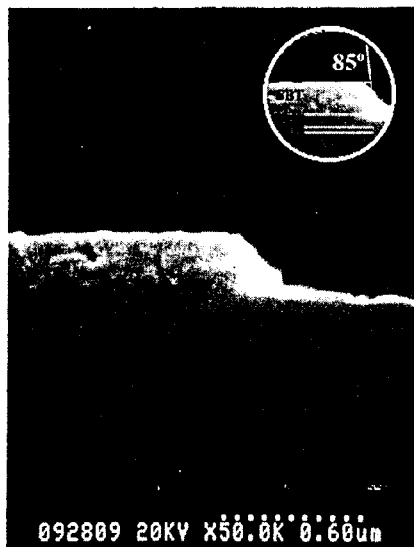
그림 4. 0.1의 \text{CHF}_3/(\text{Ar}+\text{CHF}_3) 가스 혼합비 조건에서 SBT 박막의 식각 후 단면 profile.
