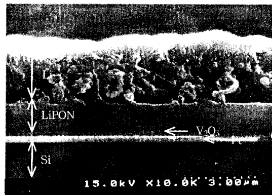
그림 3. Li/LiPON/V 2 O 5 /Pt 박막 전지의 SEM 단면 사진
