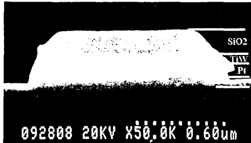
그림 6. N 2 20% 첨가 조건에서 식각되어진 Pt SEM 사진.
