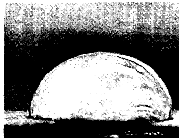
그림 11. Contact angle of wax emulsion mixed with resin (170℃).
