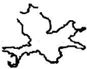
그림 2(b) \sigma=1.0 에서 LGF 사용 필터처리에 의해 추출된 그림 2(a)의 윤곽선
