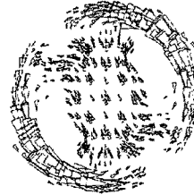
그림 17. 단면에서의 자속의 흐름도 Fig. 17. Flux Distribution in the Cut-Plane
