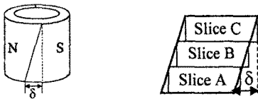
(a) 3차원 스큐 모델 (b) 2차원 스큐 해석모델 그림 6. 영구 자석의 스큐 모델
