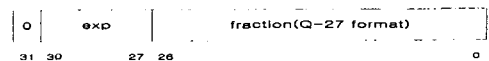
그림 3. Descaling 과정에서의 4/3승 표 구성 Fig 3. Table structure of power of 4/3 for descaling processing
