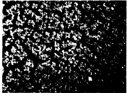
그림 4. 에틸알콜을 첨가한 HF 전해액으로 PSi 형성 후 얻은 광학현미경사진(×1000)
