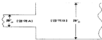
그림 3 모드정합법을 이용하기 위한 불연속 구조를 갖는 마이크로 스트립 형상
