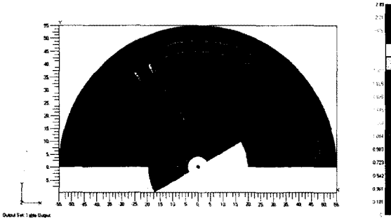
그림 8. 치 정렬시 자속밀도 분포도 (z=19mm, 기기 내부)
