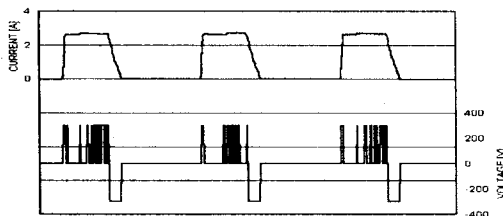
그림 7 계산결과 대입시 전류, 전압파형(1000[rpm])
