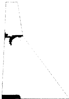
그림 5. 수평 지반운동 성분에 의한 균열손상
